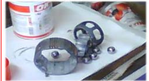
Rodamientos P6 del eje principal, conexión con la caja de transmisión
