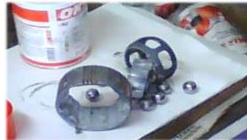
Rodamientos P6 del eje principal, conexión con la caja de transmisión
